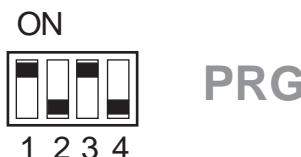
**PRG:** programmatore a 4 interruttori montato sulla scheda di logica S2 che consente di programmare tutte le funzioni dell'apparecchiatura.
